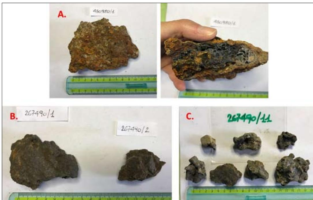
Fig. 4. Principali tipi di residui di lavorazione classificati. A- scoria a calotta; B- scorie pesanti di forma irregolare; C- frammenti di parete di fornace.
